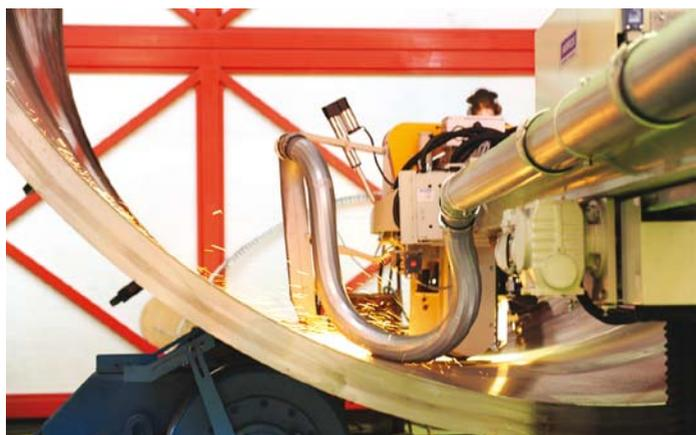
Amolado automático de soldadura en virolas de generador de vapor.
